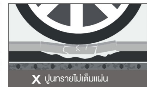
ภาพเปรียบเทียบแสดงการใส่ปูนทรายเต็มแผ่นกระเบื้อง และไม่เต็มแผ่นกระเบื้อง ซึ่งส่งผลให้การรับน้ำหนักของกระเบื้องได้ไม่เต็มประสิทธิภาพ
