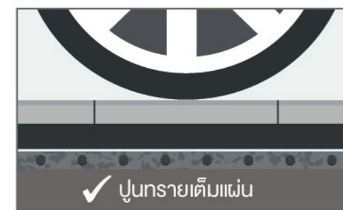
ภาพเปรียบเทียบแสดงการใส่ปูนทรายเต็มแผ่นกระเบื้อง และไม่เต็มแผ่นกระเบื้อง ซึ่งส่งผลให้การรับน้ำหนักของกระเบื้องได้ไม่เต็มประสิทธิภาพ
