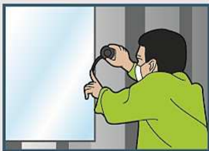
ใช้แถบสีหรือกระดาษขาว ติดแผ่นฟอยล์ที่ยื่นออกมาด้านข้างของ Roof Batt เพื่อยึด Roof Batt ให้อยู่ชิดจันทัน
