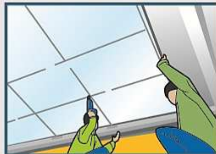
Roof Batt ที่ยึดติดกับจันทันแล้วจะเรียงเป็นแนวเดียวกัน
