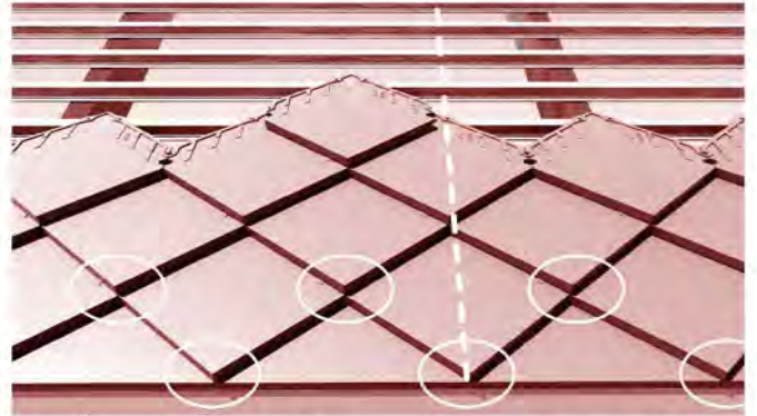
3. กระเบื้องแถวถัดไปให้ติดตั้งด้วยกระเบื้องผืนหลังคา โดยให้ปลายแหลมของกระเบื้องผืนหลังคาตรงกับแนวรอยต่อด้านข้างระหว่างกระเบื้องเชิงชายทุกแผ่น และทำการซิงสายเอ็นระหว่างเชิงชายกับสันหลังคาเพื่อบังคับแนวรอยต่อด้านข้างกระเบื้องให้ตรงกัน
